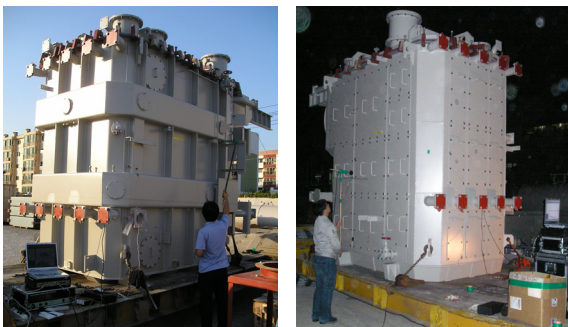
(a) 154kV 한전표준형 외함 (b) 154kV 저소음형 외함
