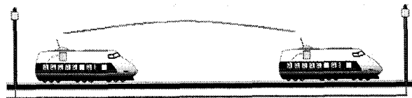
<그림 2-5> MESH를 이용한 열차 간의 무선통신
