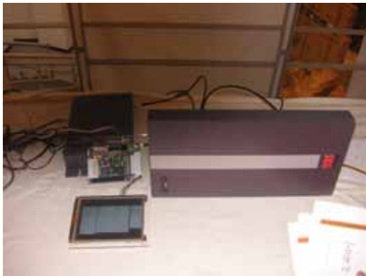
▶▶ 그림 5. RFID 리더 플랫폼 구성도
