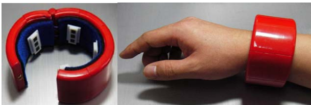
그림 6. 웨어러블 장치에 적용한 진동 촉각 장치.
