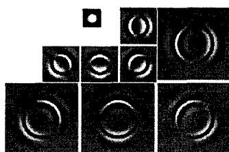
그림 2 steerable pyramid를 이용한 영상 분해의 예
