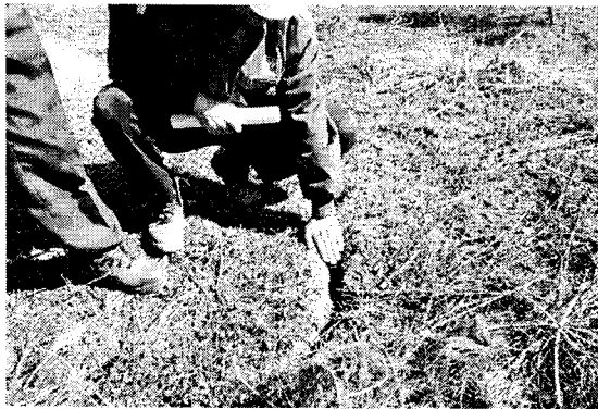
그림 7. 사면 배면균열(30~100mm, 평지측)
