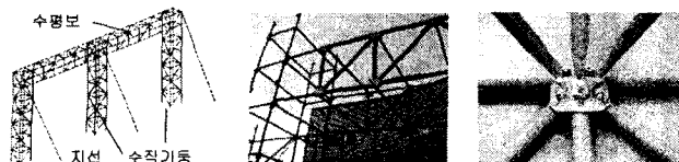
〈그림 6〉 수평보 구조 및 형태
