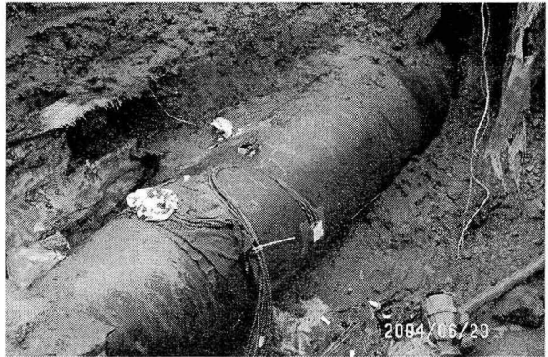
Fig. 2 스트레인게이지 배관설치 사진
