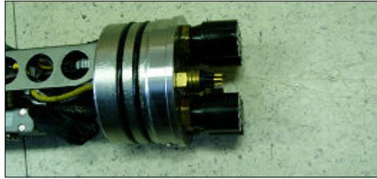
Fig. 4 제작된 압력 하우징 커넥터 장착부
