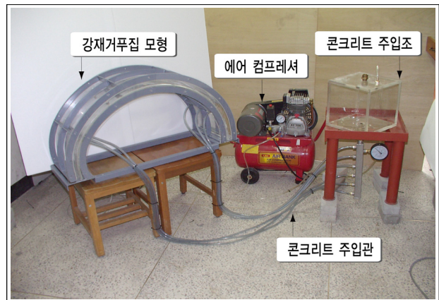
그림 2. 라이닝 콘크리트 타설모형실험 개요도
