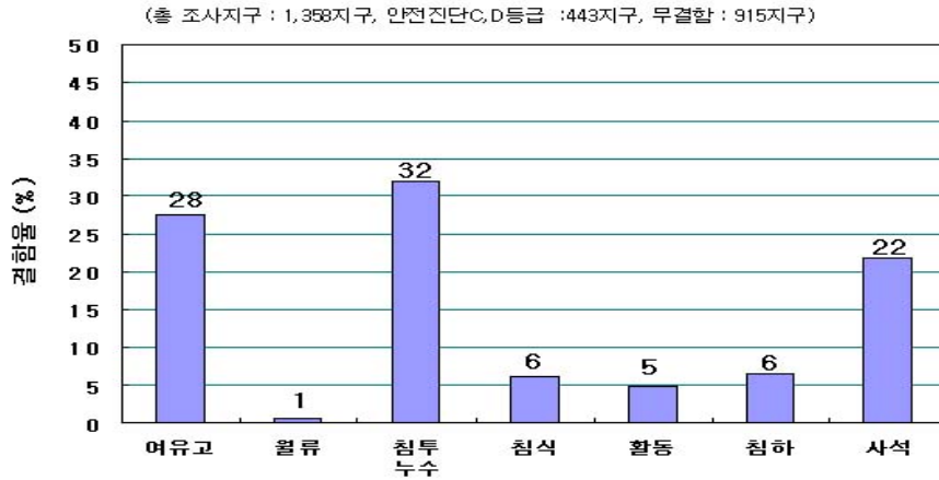
그림 6. 농업용 댐의 결함원인별 결함율(1996~2003 안전진단)
