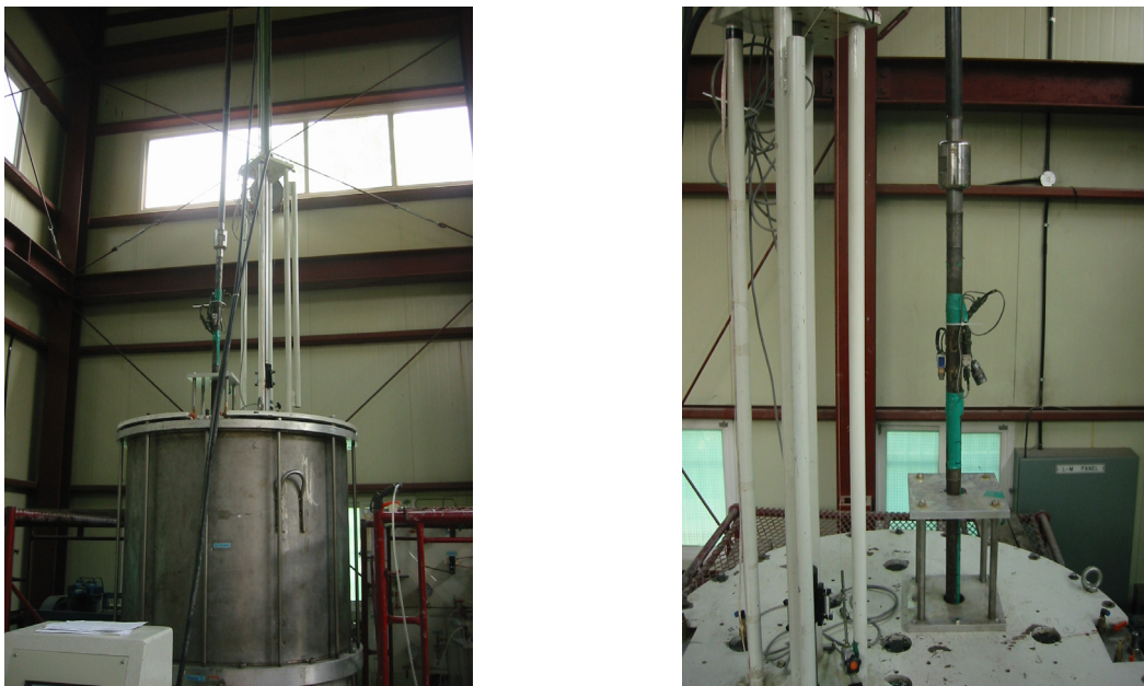
그림 8. Calibration Chamber에서의 표준관입시험
