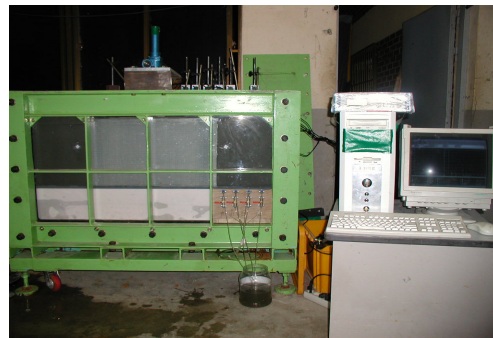
그림 6. 지반 용기량 측정 장치
