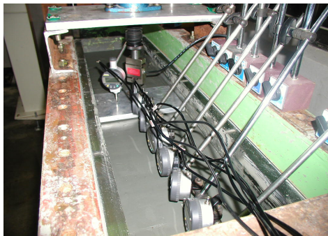
그림 5. 다이얼 게이지 설치
