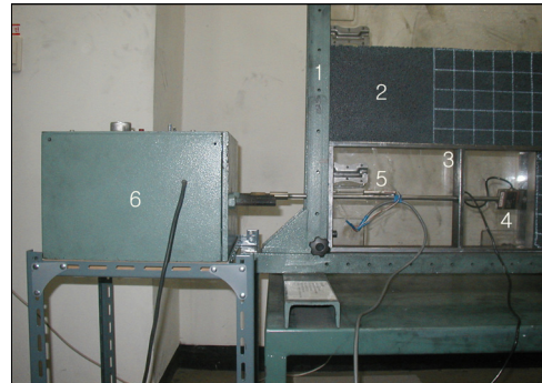
1. 탄소봉시험장치 2. 모형지반 3. 모형터널 4. Load Cell 5. LVDT 6. 변위제어장치
