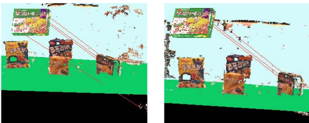
그림 6. 삼각형 제한을 안 한 경우와 한 경우 비교: 삼각형 제한을 사용하면 잘못된 대응점은 제거된다.
