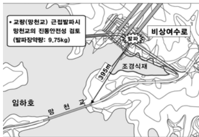
그림 4.8 망천교 근접 발파시 해석 개요도
