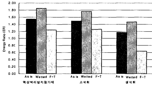
그림 8. 다양한 수분상태에서 AP5 아스팔트 혼합물 시편의 Energy Ratio 값
