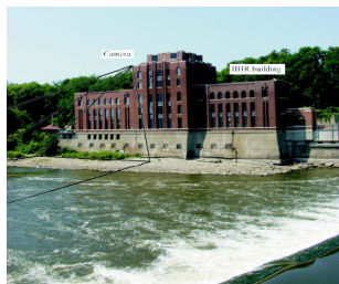
(a) 카메라의 위치 (b) Burlington교 <그림 1> Burlington교에서 고정식 LSPIV를 이용한 유량측정
