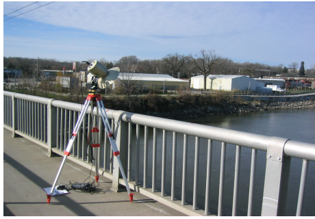
<그림 2> Benton교에서의 전자파표면유속계를 이용한 유속측정
