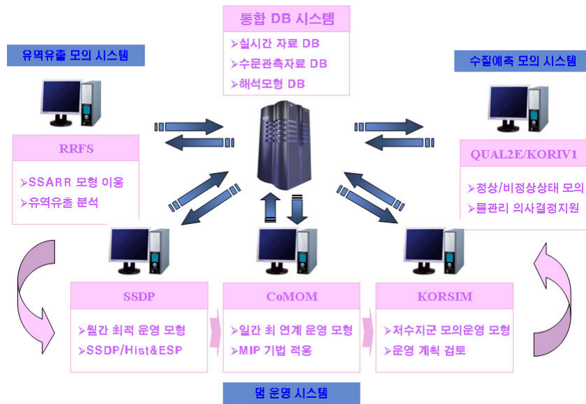
그림 1. 금강수계 실시간 물관리 운영 시스템 구조도
