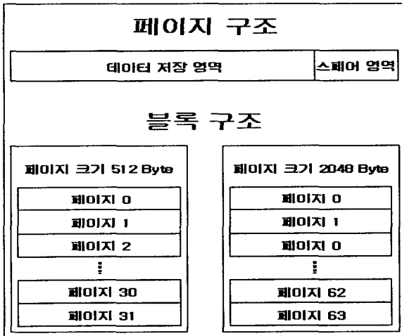
그림 1. NAND 플래시 메모리의 페이지와 블록 구조
