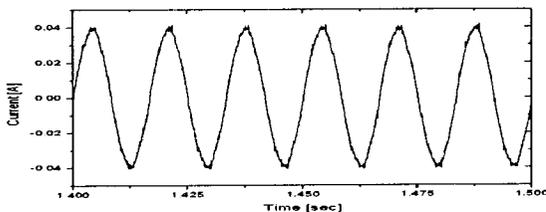
그림 6 Active Filter의 보상전류에 의해 고조파성분이 보상된 계통전류
