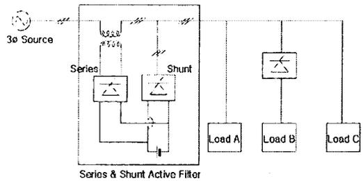
그림 1 직·병렬 Active Filter 시스템의 개념도
