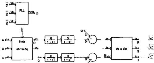
그림 4 고조파전류 보상위한 Active Filter 제어 블록 다이어그램
