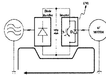
그림 1 가변속 AC 드라이브 시스템
