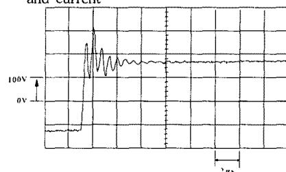
그림 9 모터 단자 전압 과정(측정 과정)
