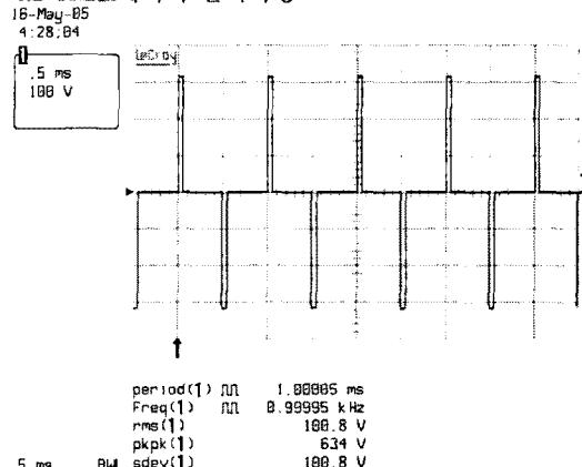
그림 6. 1KHz, 100V
