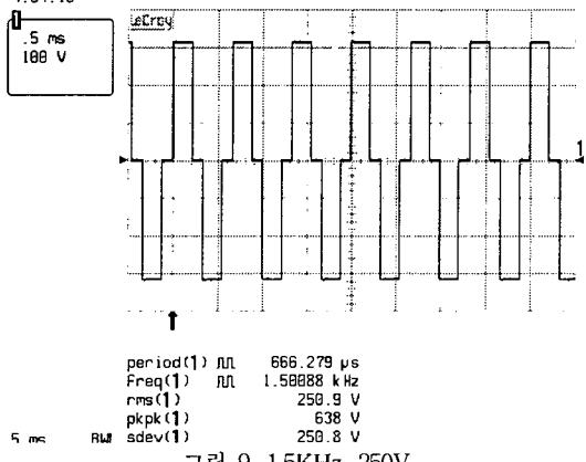
그림 9. 1.5KHz, 250V
