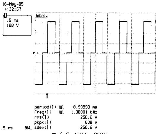
그림 7. 1KHz, 250V
