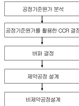
[그림1] 공정원가와 TOC개념을 적용한 제약 및 비제약공정 설계 Process
