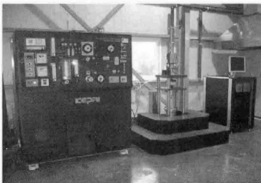
Figure 1. 저주기 환경피로 실험 장치.
