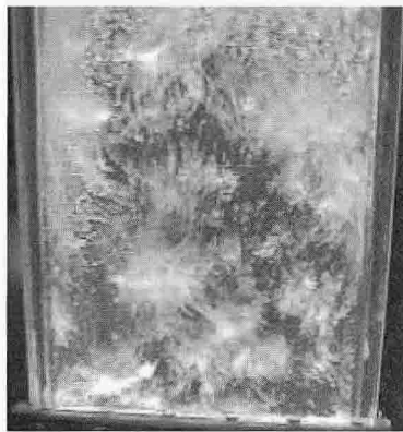
그림. 4 버블 주입기 부위에서의 버블상승 모습 측면사진, \alpha_f = 0.895
