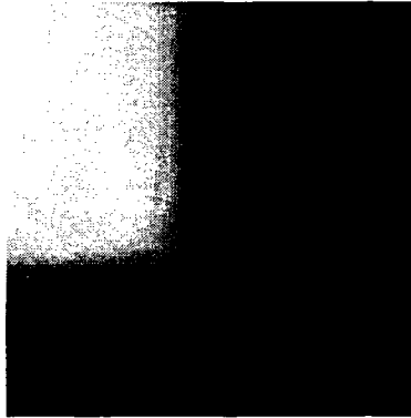
그림2. 초점평면에서 L-shape knife-edge을 통과한 빔의 세기분포
