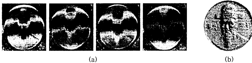
그림 3. 주사식 그림자 모아레 장치로 측정된 결과: (a) 모아레 무늬, (b) 복원된 형상
