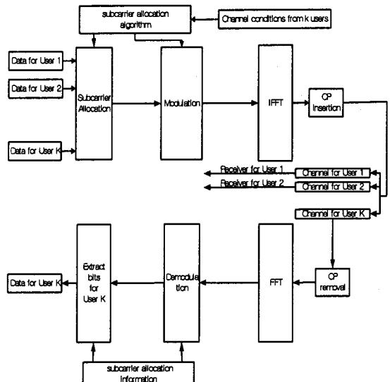
그림 1. 다중사용자 OFDM 시스템의 구성도
