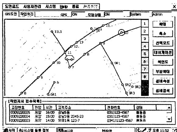
그림 2. Compact형 GIS 엔진과 GPS 연동 화면
