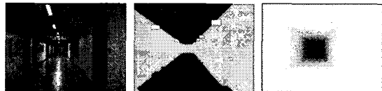
a. 일반 영상 b. 분할된 영상 c. 깊이 영상 그림 5. 영상 분할을 통한 깊이 영상 획득
