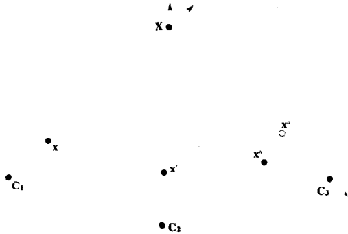
그림 1: x, x', x'' 는 주어진 영상 대응점, \bar{x} 는 triangulation으로 outlier 보정이 이루어진 영상점.
