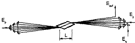
그림 1. 각도 다중통과 증폭기의 구성, E_p =펌핑에너지, E_s =입력에너지, E_{out} =출력에너지, L =증폭매질의 길이.
