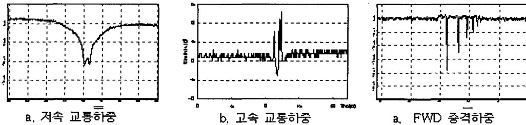
그림 18 하중형태별 콘크리트 변형률 데이터
