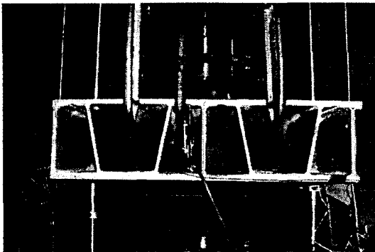
사진 3.2 복합소재 바닥판의 피로시험 모습
