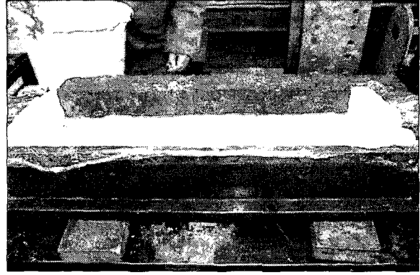
그림 3. 시험시편이 설치된 전단상자 모습
