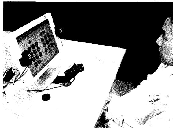
그림2 Eye-gaze Interface System
