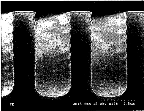
그림 5 수평형 트렌치 파워 MOS를 제작하기 위한 트렌치 공정을 수행한 후 웨이퍼의 SEM 단면도
