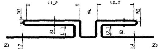
그림 5. 결합 전송선로를 이용한 제안된 정합회로
