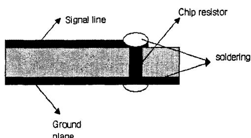
그림 1. 칩 저항을 이용한 포트 정합  $45 \Omega$
