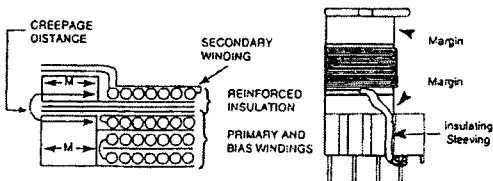
그림 1. 변압기 creepage distance를 위한 margin
