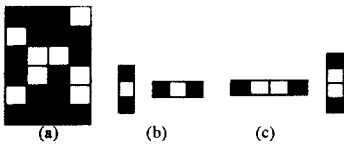
그림 3. hole 비율의 예 (a) 화소 = 24, hole = 8 일때 비율 = 34 % (b) 1 화소 hole 의 인식 (c) 2 화소 hole 의 인식
