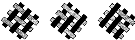
(a) diamond (b) regular (c) hercules 그림 3. 브레이드 패턴
