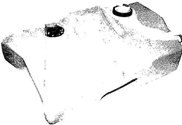
그림 13. 가솔린연료탱크과 동일한 형태의 LPG 연료탱크 (프랑스 Roxer 사 개발)
