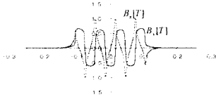
그림 2. 자석에 의한 자속밀도(공간고조파법)
