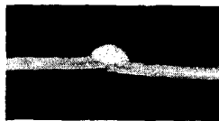
(a) root gap: 0mm, 100cm/min, 55A, 14V
