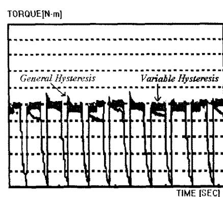
그림 7 히스테리시스 전류제어기에 의한 정상상태 토크의 파형
