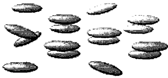
그림 1. 자성입자의 분포계수 정의 ( \sigma_\alpha : x-y 평면에서의 입자들의 분포계수 \sigma_\beta : x-z 평면에서의 입자들의 분포계수)
