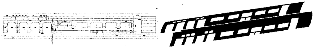
그림 4. The Drawing Design and Finite Element Model of TT5 Side Frame Assembly
