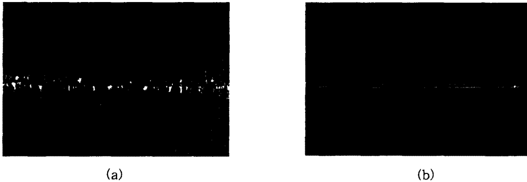
그림 1. ICCD 카메라로 촬영된 코로나 형상, (a) 펄스전력을 공급한 경우의 스트리머 코로나 (b) DC전력을 공급한 경우의 코로나
