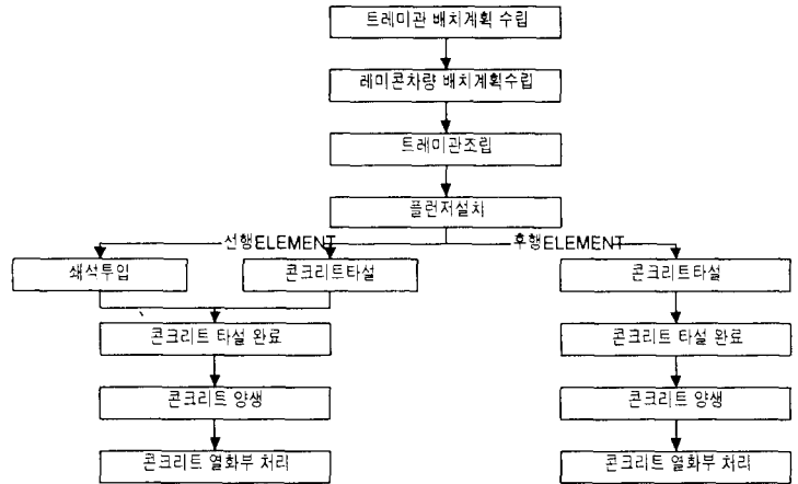
그림 17. 콘크리트 타설 Flow
